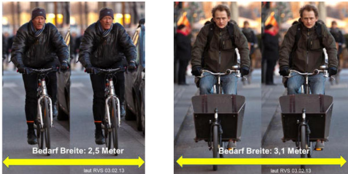
Abbildung 9: Vergleich des Lichtraums verschiedener Fahrradtypen auf Basis von Mindestbreiten nach RVS 03.02.13 (eigene Bearbeitung, 2023)
