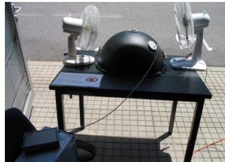
Abb. 6: Optische Integrationskugel im Außentest
