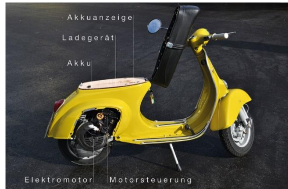
eVespa - Bj. 1969 - 5,5PS - 50km Reichweite - 75km/h
