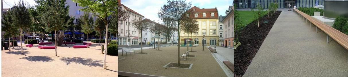
Abbildung 160: Beispiel des Einsatzes innovativer, ökologischer und wasserdurchlässiger Bodenbeläge im öffentlichen Raum
